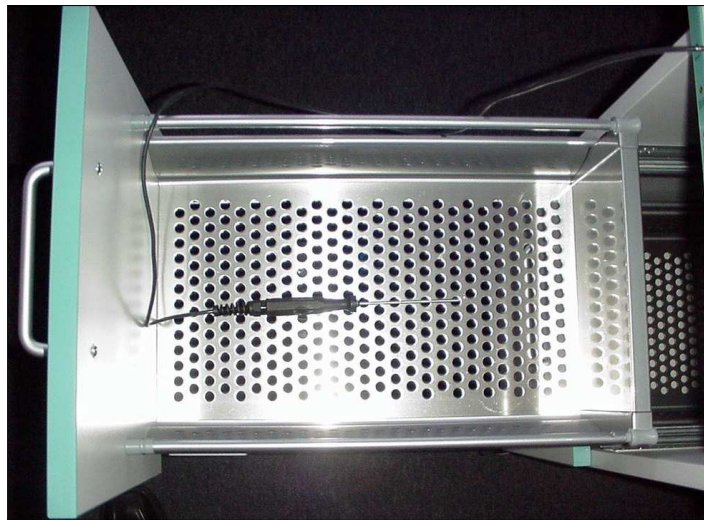
Abbildung 4: Platzierung des Referenzthermometers
